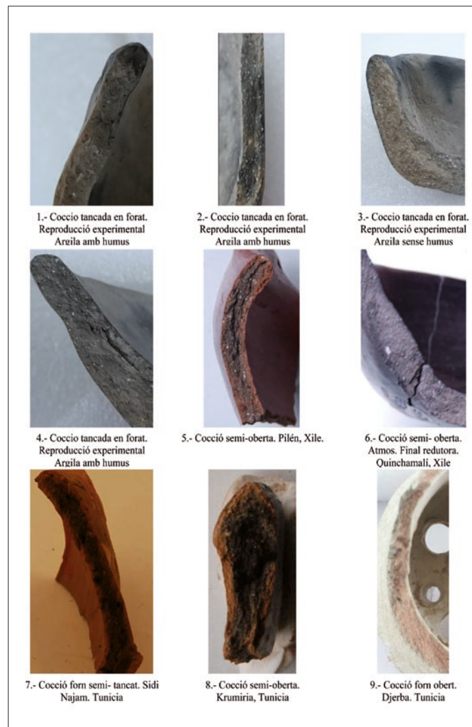
Figura 5: Talls transversals de ceràmiques procedents de coccions etnogràfiques
