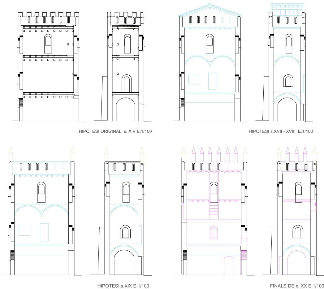
Fig. 7 Alçats amb l'evolució constructiva de la torre realitzats per Joan Pascual.
