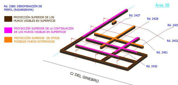
Figura 5. Interpretación o modelización “tridimensional” del área 3a (arriba) y área 3b (abajo). en ella están representados los muros total/o parcialmente visibles así como los que se encuentran soterrados.
