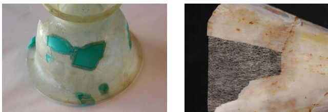
Figures 10 i 11. Motlles de silicona preparats per rebre la resina espatulada i preparació del paper japó.
